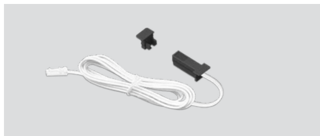
Interruttore a sfioro ON-OFF / DIMMER (10-100%) - Range: 3-6cm MAX: 1,5A - 36W (Lampada fino a 3600mm)
